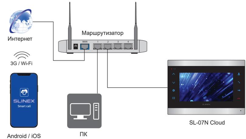
Подключение домофона SL-07N Cloud к сетевому интерфейсу посредством беспроводного Wi-Fi соединения.
