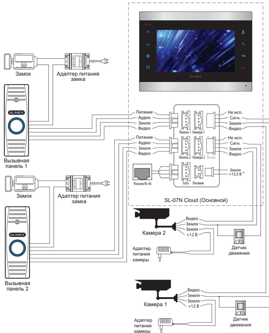
Схема 2. Подключение системы домофонов SL-07IN Cloud и Sonik 7.
